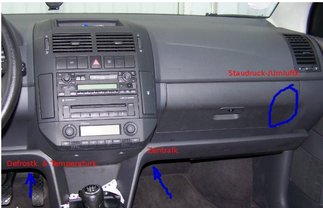
Abbildung 2: Position der Klappen-Antriebe unter dem Armaturenbrett bzw. Handschuhfach
