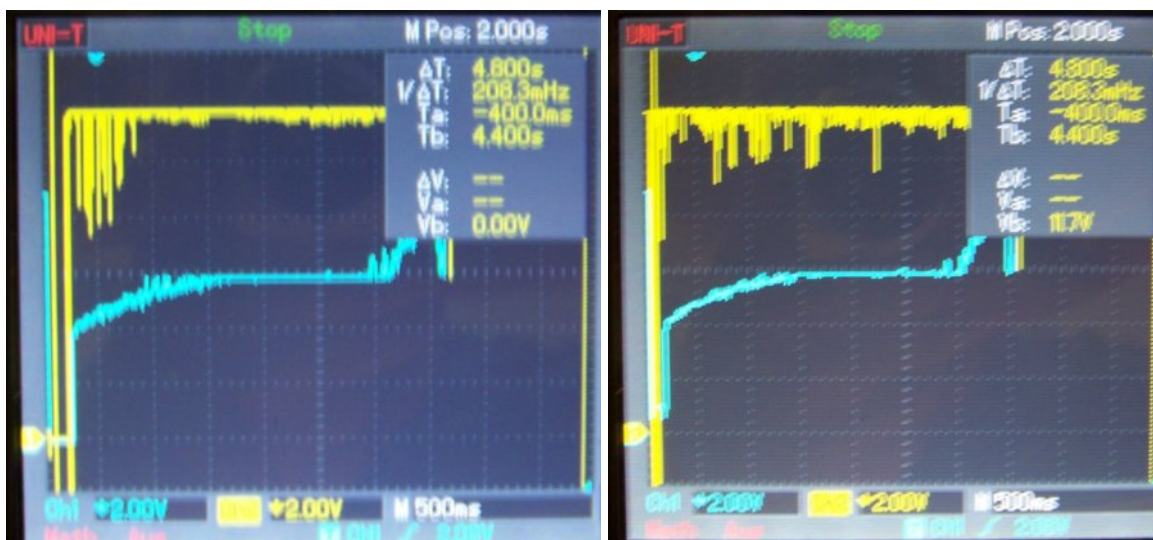
Abbildung 16: Messungen am Staudruck- / Umluftmotor vor der Reinigung in Richtung 2
