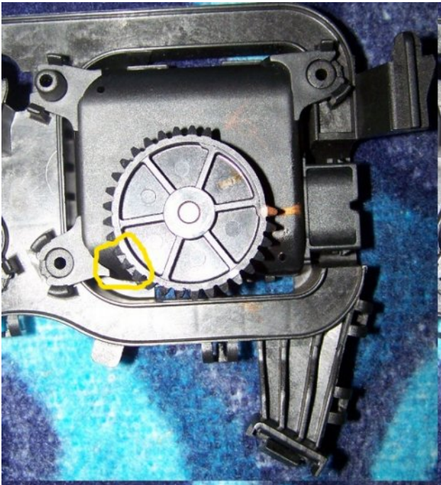
Abbildung 11: Temperaturklappe mit goldener Startmarkierung
