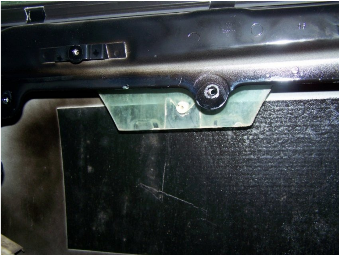
Abbildung 4: Detailansicht des Spreizdübels mit Spreizstift (hier Beifahrerseite nach dem Wiedereinsetzen)
