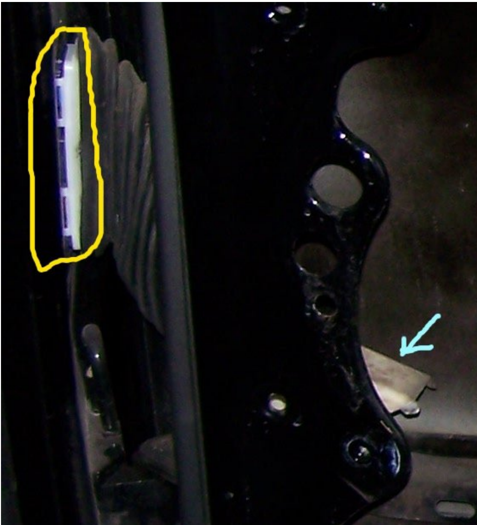
Abbildung 5: Detailansicht des Faltenbalgs (hier Beifahrerseite)
