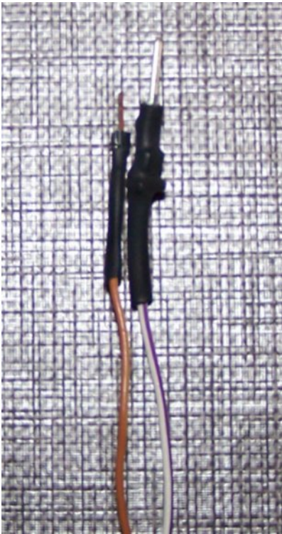
Abbildung 13: Enden von 2 unterschiedlichen Messleitungen (links Jumper-Pin, rechts AMP)
