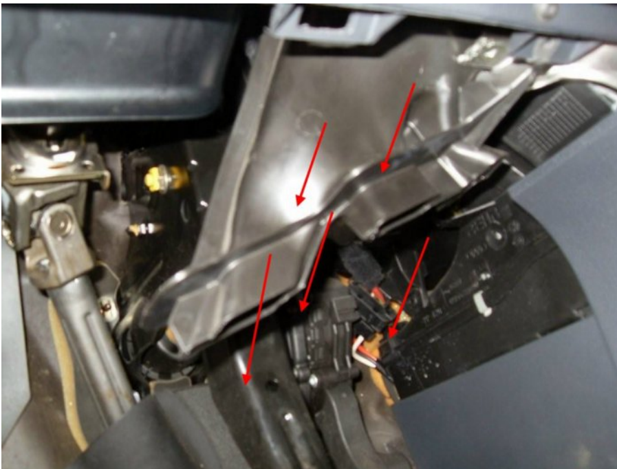
Abbildung 7: Luftkanal nach links außen abziehen (Pfeile sind etwas unglücklich gemalt) [1]
