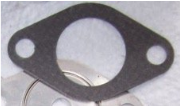
Abbildung 17: Neue Dichtung für den Abgaskühlereingang
