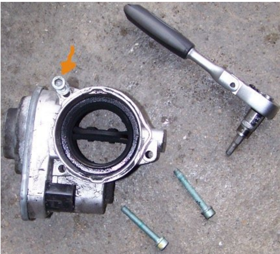
Abbildung 6: ausgebaute Drosselklappe, 3 Schrauben/Unterlegscheiben und Werkzeug
