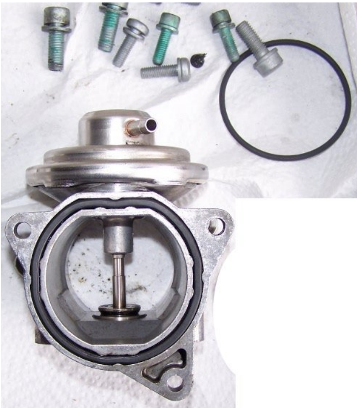
Abbildung 18: AGR-Ventil vor dem Einbau mit neuem Gummiring und Original + Ersatzschrauben
