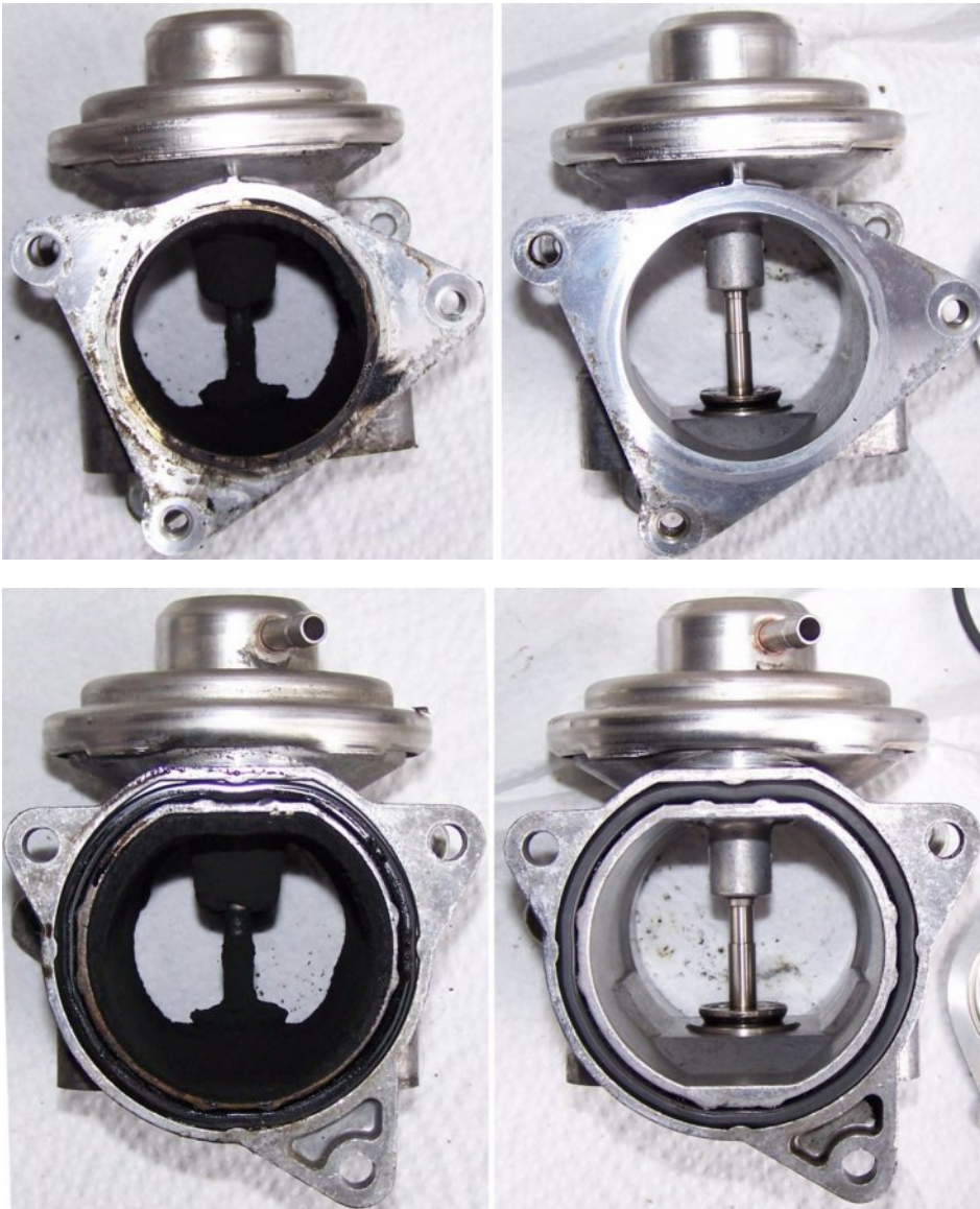
Abbildung 15: Vorher-Nachher Vergleich des AGR-Ventils
