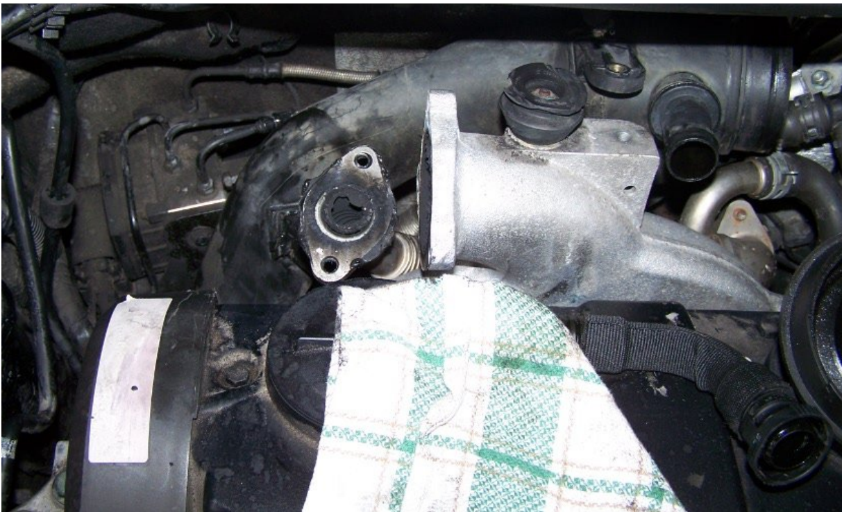
Abbildung 10: Blick auf Ansaugbrücke von vorn
