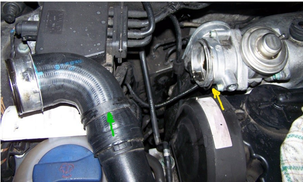
Abbildung 4: Abgezogener und verdrehter Schlauch
