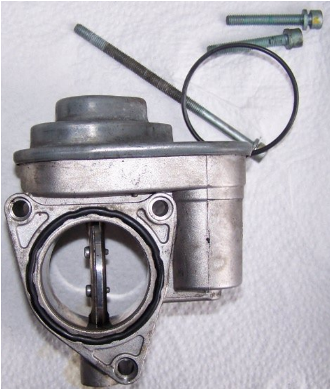
Abbildung 19: Drosselklappe vor dem Einbau mit neuem Gummiring und Schrauben
