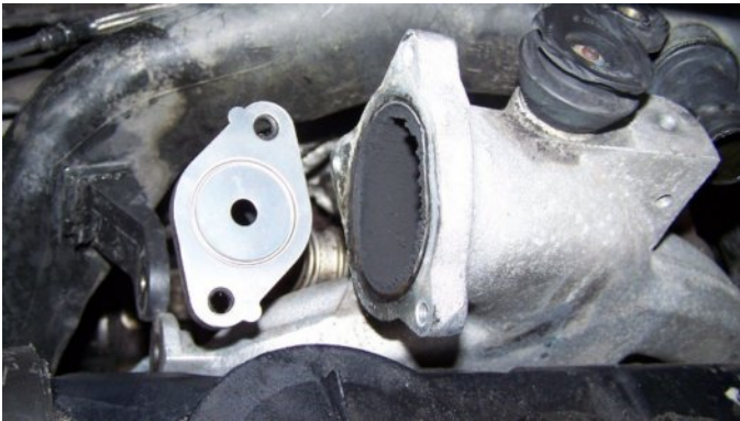
Abbildung 8: Nach Ausbau: neue Dichtung mit kleinerem Durchmesser testweise aufgelegt
