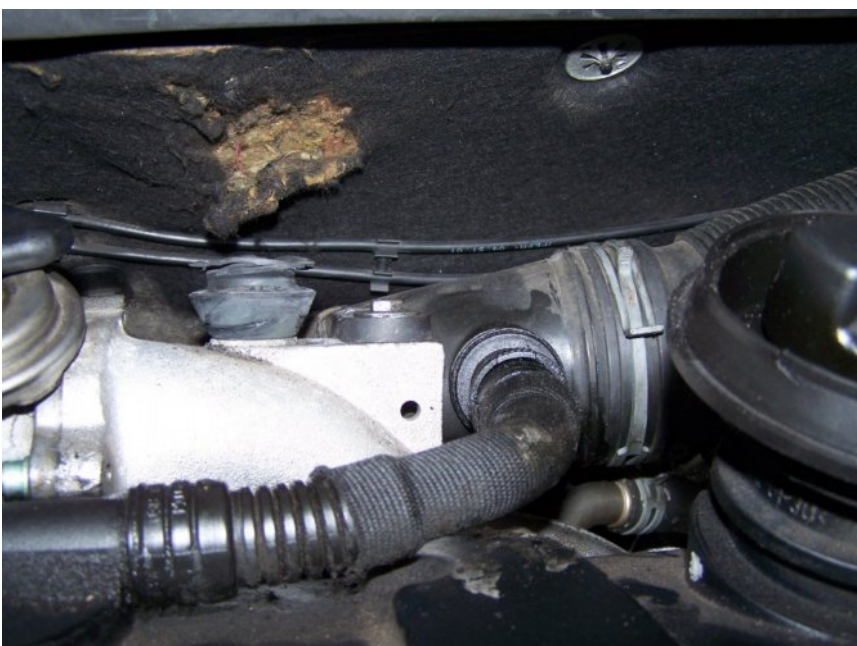
Abbildung 1: Frischluftweg vor dem Turbolader
