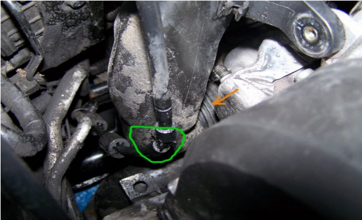
Abbildung 11: Blick auf Befestigung Frischluftkanal zum Turbolader
