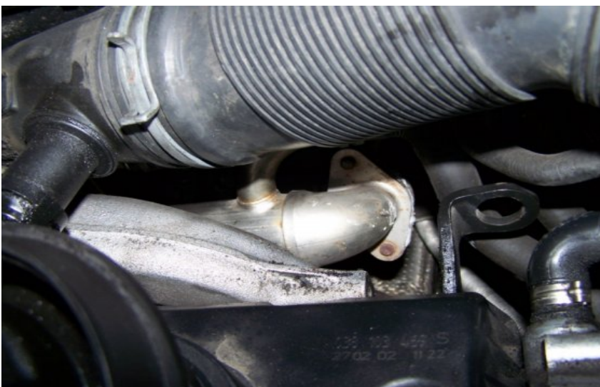
Abbildung 2: Luftweg nach dem Turbolader
